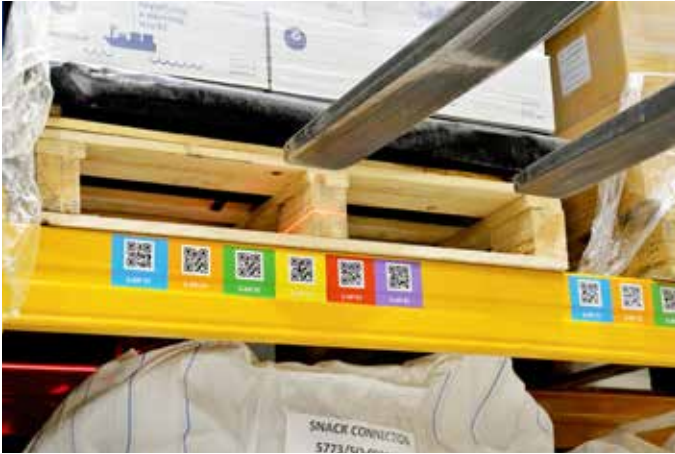
De in de vorken ingebouwde laser ondersteunt de chauffeur.
