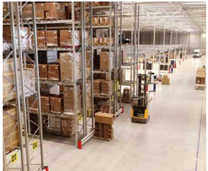
Op kritieke punten is aanrijdbeveiliging geplaatst om schades te voorkomen.
