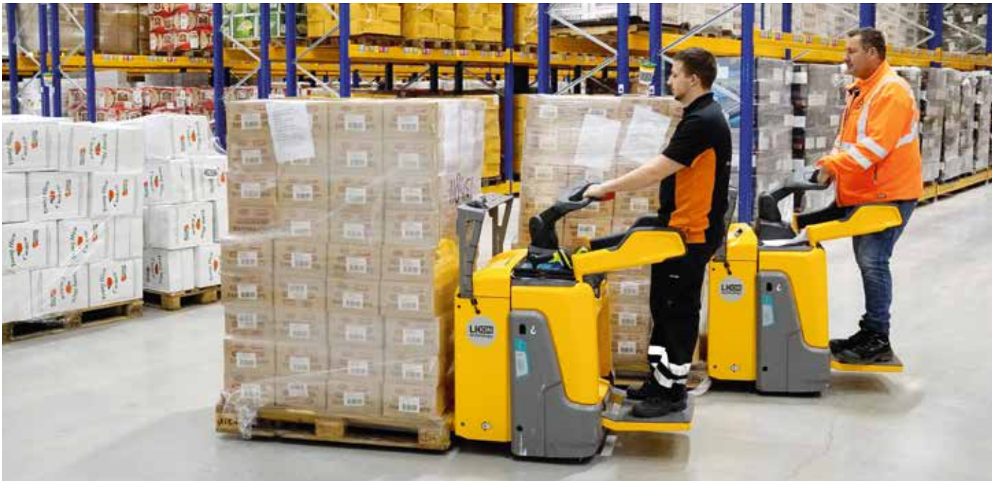
De gesloten behuizing van de lithium-ion accu's komt de voedselveiligheid ten goede.
