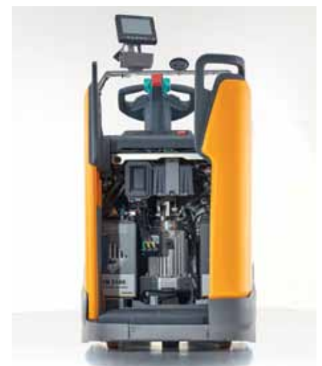
Blick ins Innenleben: Die kompakte Lithium-Ionen-Batterie fügt sich links neben der Antriebseinheit nahtlos ein.
