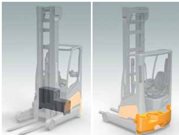
Beim Schubmaststapler ETV 216i wurde die Lithium-Ionen-Batterie intelligent im Fahrzeug platziert.
