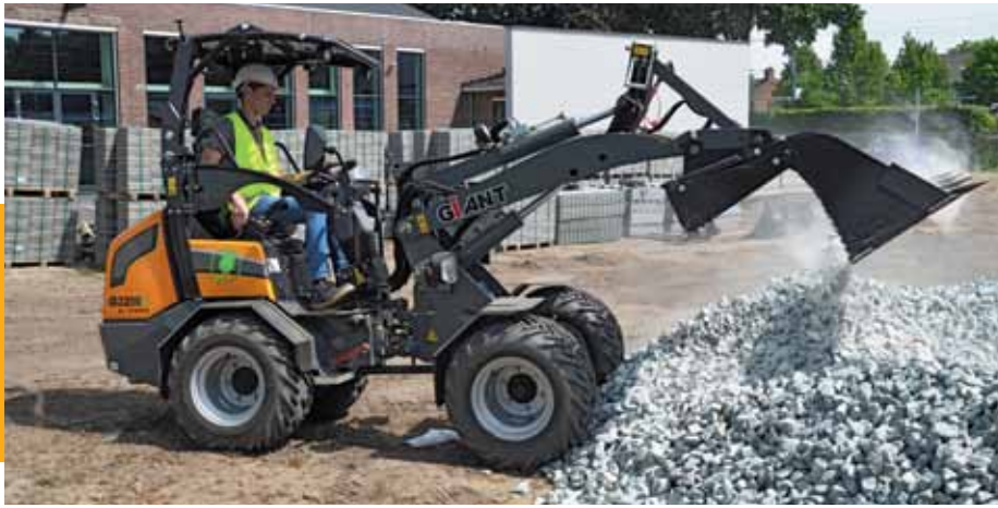
Der G2200E und der G2200E X-TRA sind Radlader mit einem Einsatzgewicht von 2,2 Tonnen und die ersten elektrischen Maschinen, die bei Tobroco-Giant gebaut wurden.
