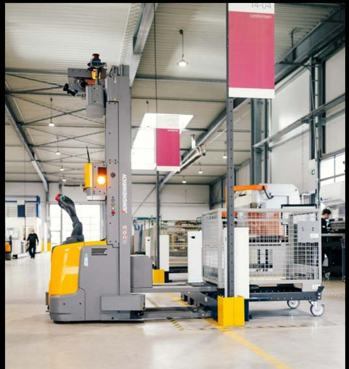
Bei DAX ist ein FTF vom Typ ECR 213a im Einsatz. Es übernimmt 22 Transporte pro Stunde und schleust so rund 80 Prozent der Teile bei DAX automatisiert durch den Fertigungsprozess.
