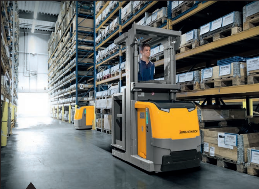
Der EKS 110 ist besonders robust mit stoßgeschützter Antriebshaube.
