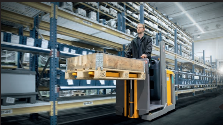
Energie-Rückgewinnung durch regeneratives Abbremsen. Serienmäßig ab Baureihe 1.
