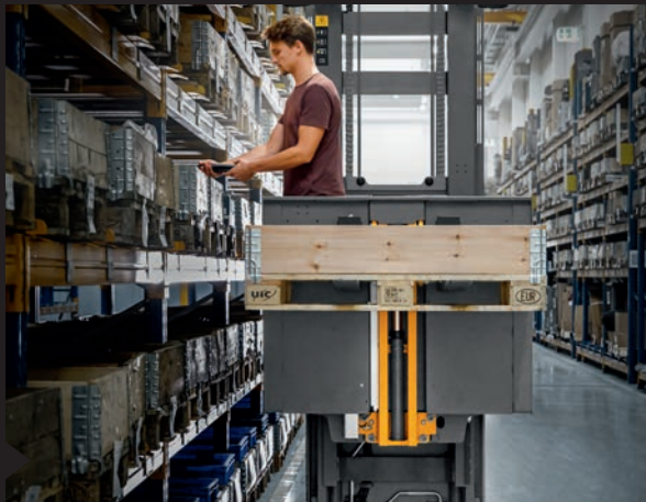
Der EKS 110 ist besonders robust mit stoßgeschützter Antriebshaube.
