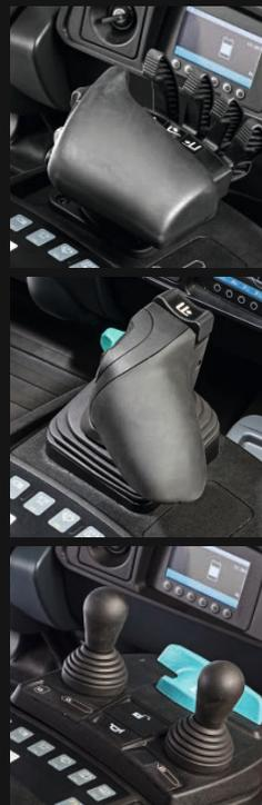
**soloPILOT:** Alle Hydraulikfunktionen, Fahrrichtungswahl und Hupe in einem Hebel. Millimetergenaue Steuerung sämtlicher Funktionen.
