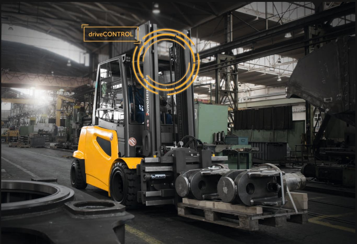
Mit **tiltCONTROL** wird der Neigungswinkel des Mastes automatisch an die Last angepasst.
