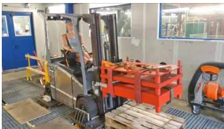
Рис. 4. Стендовая симуляция езды по неровной поверхности с грузом
