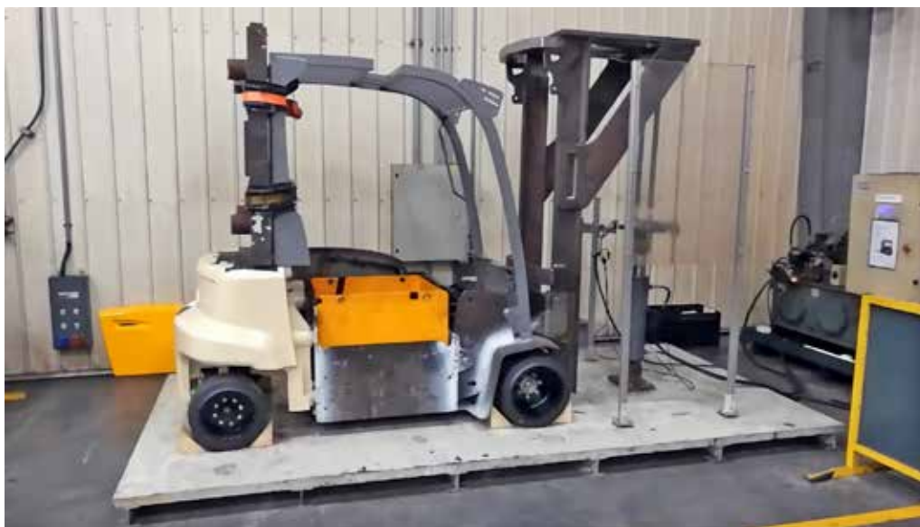
Рис. 3. Испытания всех функциональных соединений рамы — пульс-тест
