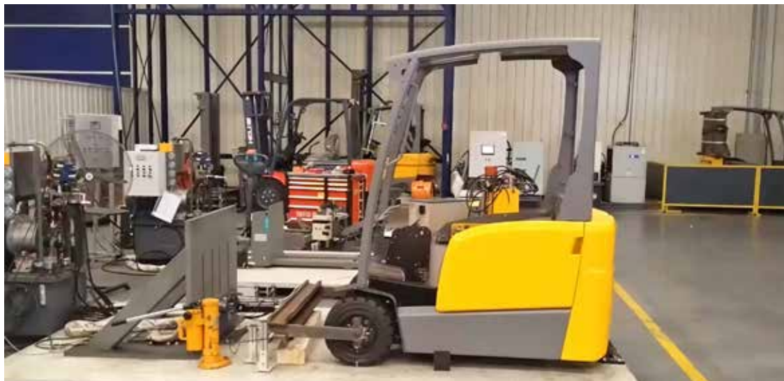
Рис. 5. Стендовая симуляция ускорения и торможения с грузом
