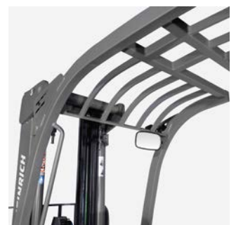
Typisch für die Baureihen BB und BC: bogenförmiges Fahrer-schutzdach für optimale Sicht.
