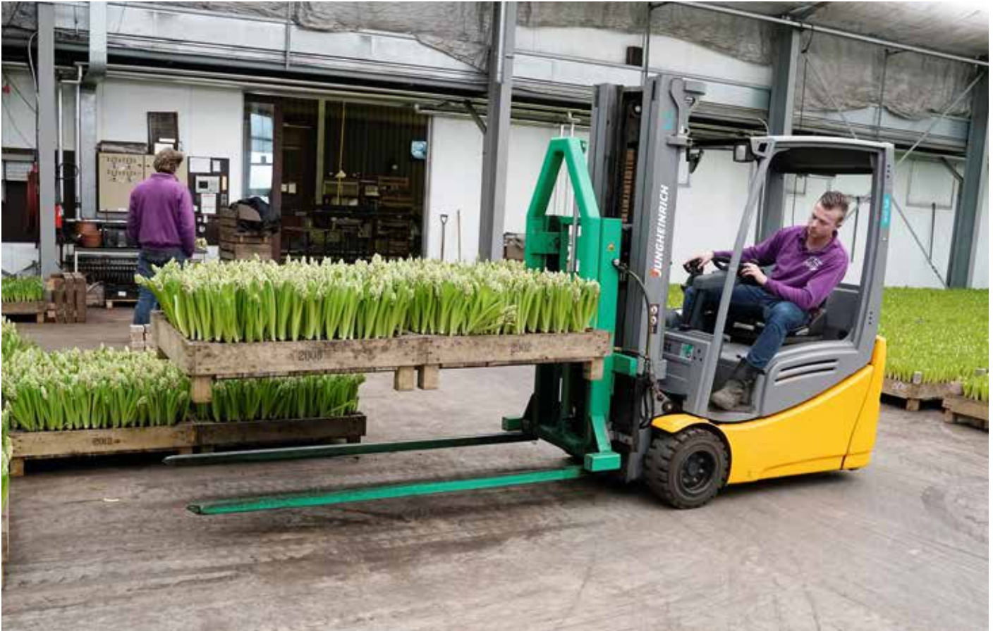
Ook de nieuwste EFG 218k heftruck is uitgevoerd met een vierde hydrauliekventielfunctie voor de kanteling van kisten.
