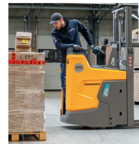
Als größter Vorteil erweist sich in der vollbepackten Umschlaghalle, dass der ERD 220i um 30 Zentimeter kürzer und dadurch erheblich wendiger ist als andere Fahrzeuge seiner Klasse.
