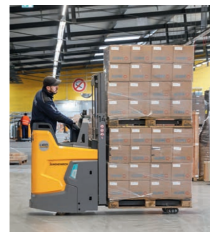
Der ERD 220i ist auch als Doppelstock einsetzbar und kann zwei Paletten übereinander transportieren. Ein erheblicher Effizienzgewinn insbesondere beim Be- und Entladen von Lkw.
