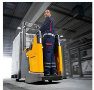
Geräumige Standplattform für maximale Ergonomie und Sicherheit der Bedienenden. Optional mit Fußschuttsensor.
