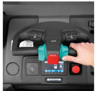
Die elektrische Deichsellenkung smartPILOT ermöglicht präzises und leichtes Lenken mit einer Hand.
