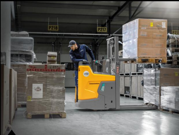
Optimierte Standfläche mit dreiseitigem Schutz sorgt für mehr Sicherheit.
