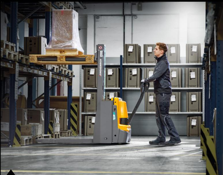
Kompakt, wendig und leistungsstark, selbst in engen Gängen: der EJD 118i mit innovativer Lithium-Ionen-Batterie.
