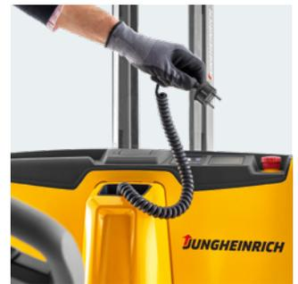
Schnell wieder einsatzbereit: Das integrierte Ladegerät ermöglicht das Wiederaufladen an jeder 230-V-Steckdose.
