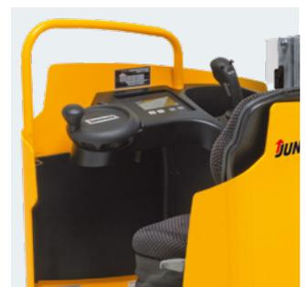
Die leichtgängige elektrische Lenkung und die komfortablen Bedienelemente des ESD 2 ermöglichen eine maximale Kontrolle aller Fahrfunktionen, auch ohne Umgreifen.
