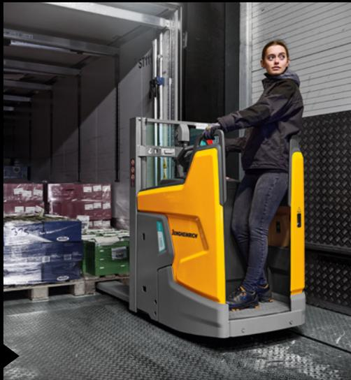
ERD 220i: Die optionale Lkw-Erkennung reduziert automatisch die Geschwindigkeit – für mehr Sicherheit beim Befahren der Laderampe und beim Rangieren.
