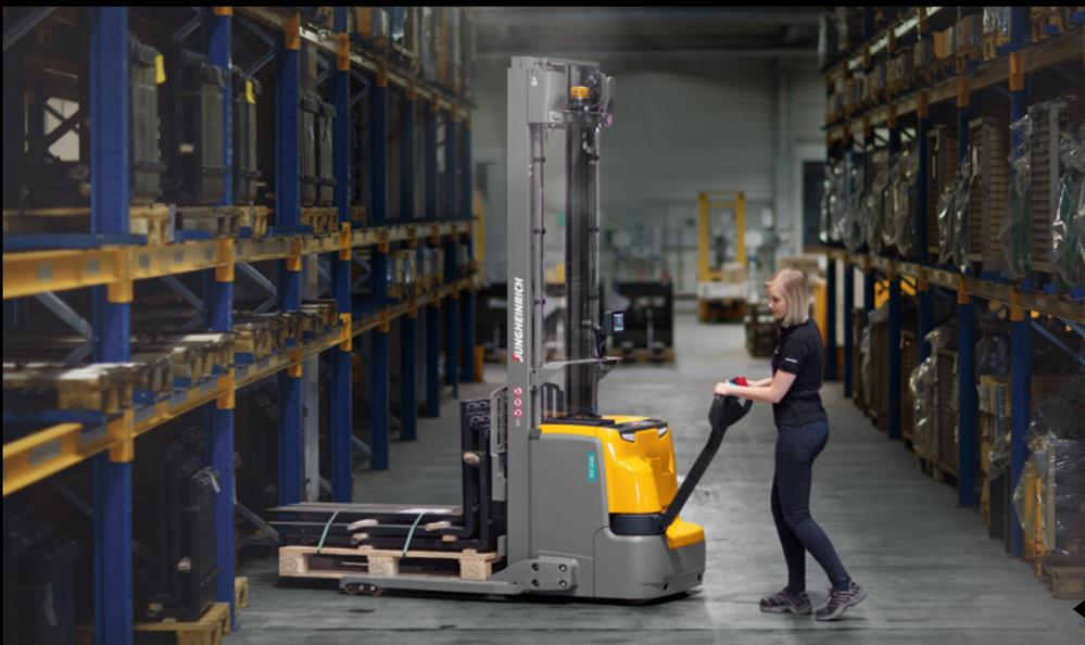
Der EJC 216b ist speziell für die Handhabung von Sondergütern ausgelegt. Durch seitlich herausgezogene Radarme können auch geschlossene Paletten oder Querpaletten aufgenommen werden.
