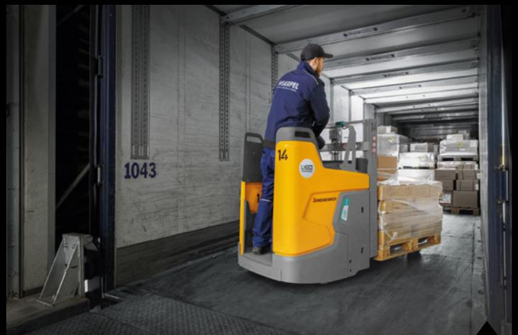
Durch die Erkennung des Lkw-Umfelds bremsst das Fahrzeug automatisch ab und die intensive Rampenfahrt wird deutlich rückschonender.
