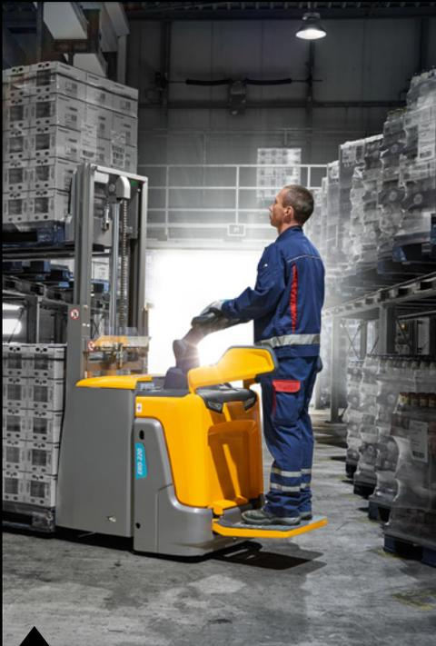
Der ERD 220 mit klappbarer Plattform. Die platzsparende, flexible Lösung für ein enges Lagerumfeld.
