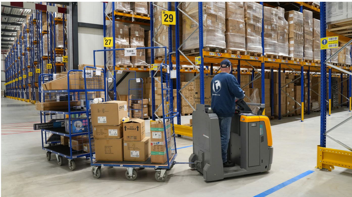
Orders worden verzameld door een sleeptrein onder aansturing van een elektrische trekker.
