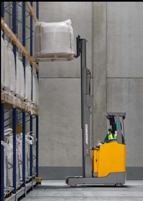
Agil und wirtschaftlich: Der Schubmaststapler ETV 216i mit Lithium-Ionen-Technologie ist prädestiniert für effizientes Ein- und Auslagern in Hubhöhen bis zu 13 m.
