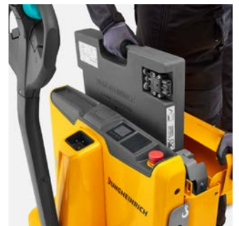
Die Batterie kann mit wenigen Handgriffen entnommen und ersetzt werden.
