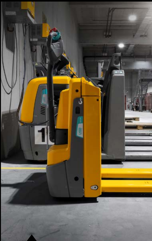
EJE 114i: Einbauladegerät für schnelles Laden an jeder 230-V-Steckdose. 50% Ladung bereits in einer 30-Minuten-Pause. Nur 60 Minuten für eine vollständige Ladung.
