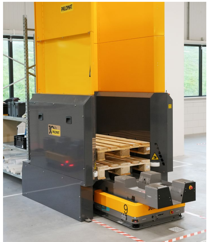
Lege pallets worden opgeslagen en opgehaald uit de Palomat door de AMR's voor maximale beschikbaarheid.
