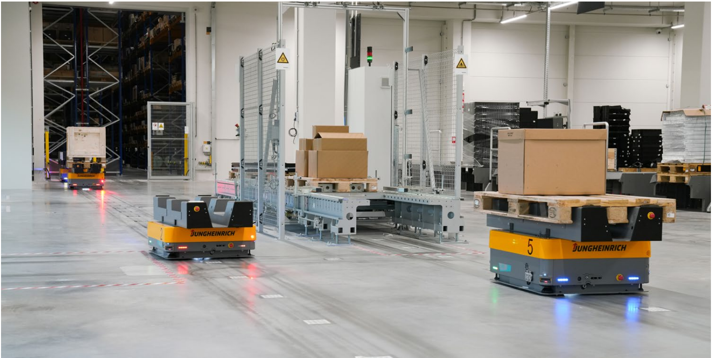
15 arculee S autonome mobiele robots (AMR's) kunnen de grote verscheidenheid aan goederen verwerken.
