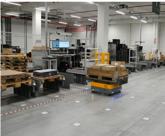
Pallets worden geplaatst op of opgehaald uit zes orderpick-stations, elk uitgerust met zes pick up/drop off-stations.
