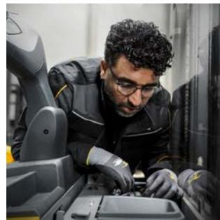
Zum Prüfungsumfang gehört die Kontrolle zahlreicher Komponenten für einen sicheren Betrieb, darunter die Sicht- und Funktionskontrolle von Antrieb, Fahrwerk und Gabelzinken.
