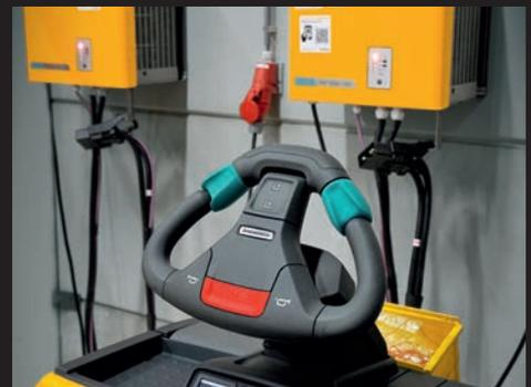
DHL hat klare Regeln zum Laden der neuen Batterien. Die Transportfahrzeuge mit Lithium-Ionen-Batterien werden während der Kaffeepausen an ein nahe gelegenes Schnellladegerät angeschlossen. „In nur 15 Minuten sind die Batterien wieder voll, sodass alle Transportfahrzeuge während des 13-stündigen Betriebs eingesetzt werden können. Die Transportfahrzeuge müssen auch abends nicht ans Ladegerät, und wir können sicher sein, dass sie am nächsten Tag wieder voll einsatzbereit sind“, erklärt Leenderse.
