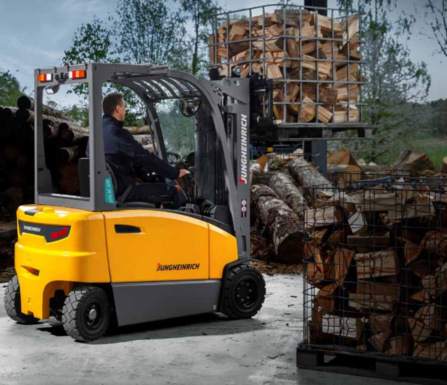
Die vielseitigen Vierradstapler **EFG BC 316-330** stemmen problemlos bis zu 3 t, wobei sie besonders in Kurven mit maximaler Stabilität und Manövrierfähigkeit glänzen. Eine hoch aufgehängte Pendelachse sorgt zum Ausgleich grober Fahrbahnunebenheiten für eine gleichmäßige Gewichtsverteilung auf alle vier Räder. Neben hoher Performance bei niedrigem Verbrauch bestechen die Stapler durch robuste, langlebige Komponenten und ein optimales Preis-Leistungs-Verhältnis.
