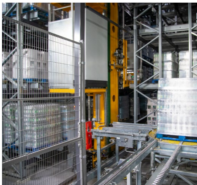
Via een conveyor wordt de pallet afgeleverd bij het juiste gangpad en op de UPC-shuttle gereden, die op de magazijnkraan klaarstaat.
