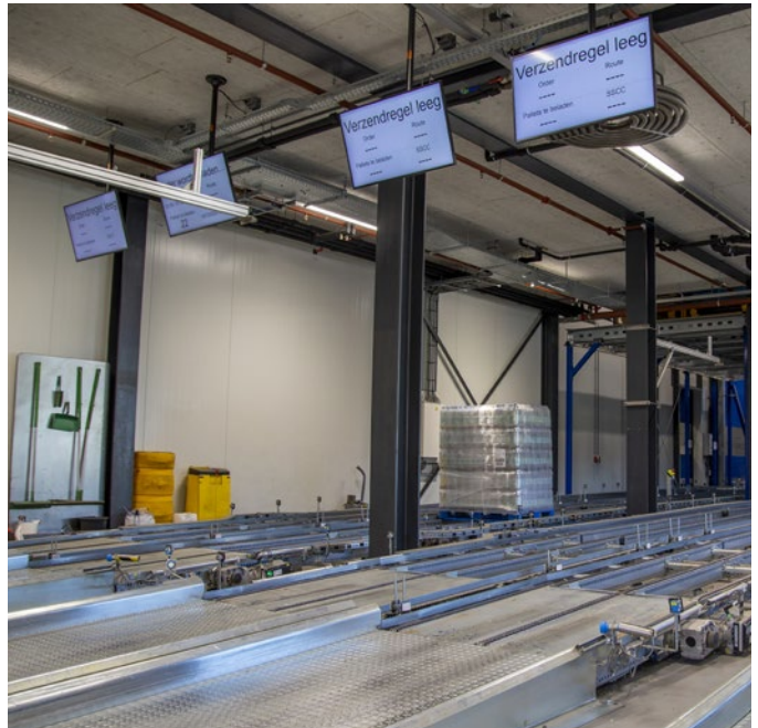
Uitgaande goederen uit de hoogbouw worden automatisch naar de expeditievloer getransporteerd, hier komen geen mensenhanden meer aan te pas.
