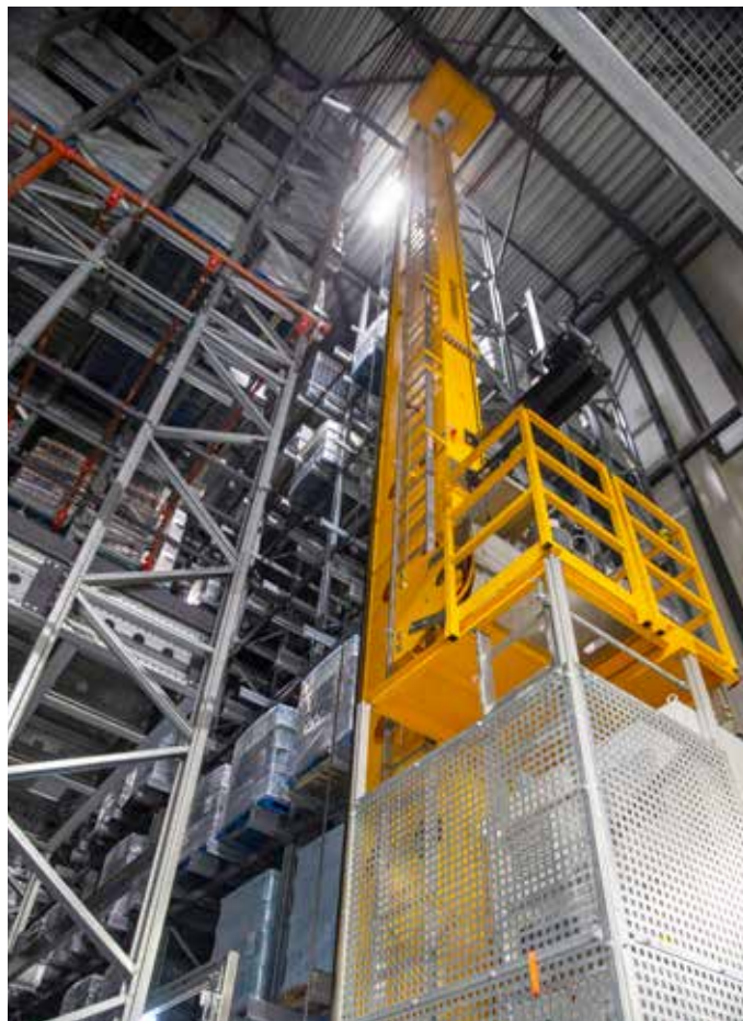
Het 21 meter hoge warehouse biedt ruimte voor een kleine 8.000 pallets, die multidiep worden opgeslagen.
