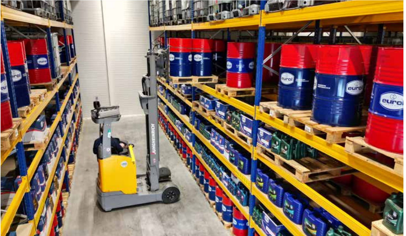
Met de ETV C-reachtruck werkt Van Staveren nu in smallere gangpaden en kunnen ook de 1.000 liter IBC's tot zeshoog worden in- en uitgeslagen.
