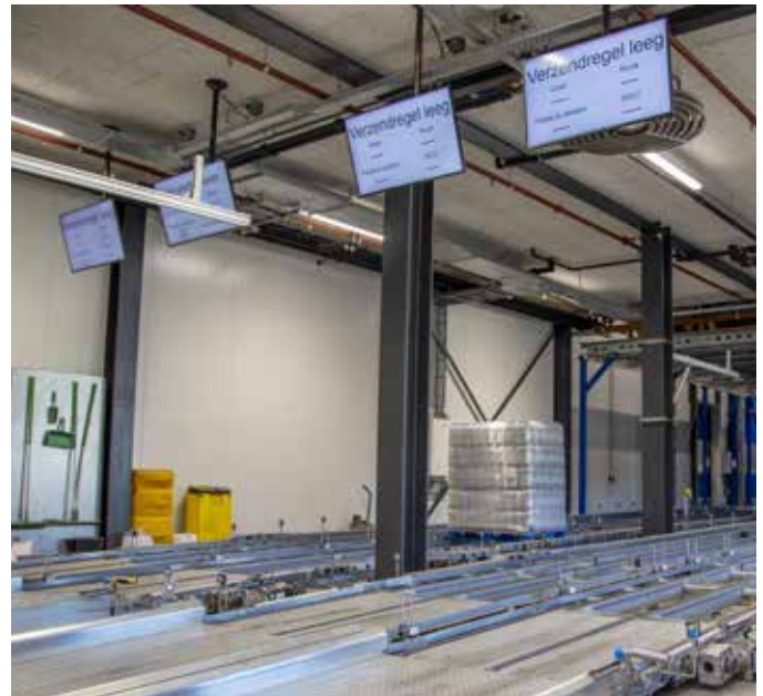
Uitgaande goederen uit de hoogbouw worden automatisch naar de expeditievloer getransporteerd. Er komen geen mensenhanden meer aan te pas.
