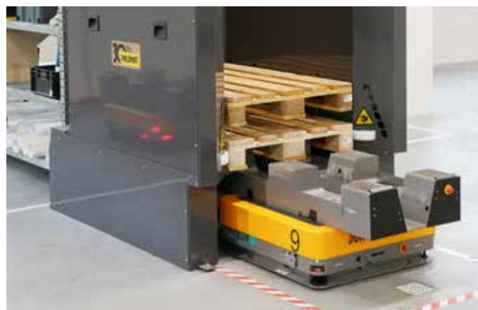
Lege pallets worden opgeslagen en opgehaald uit de Palomat door de AMR's voor maximale beschikbaarheid.
