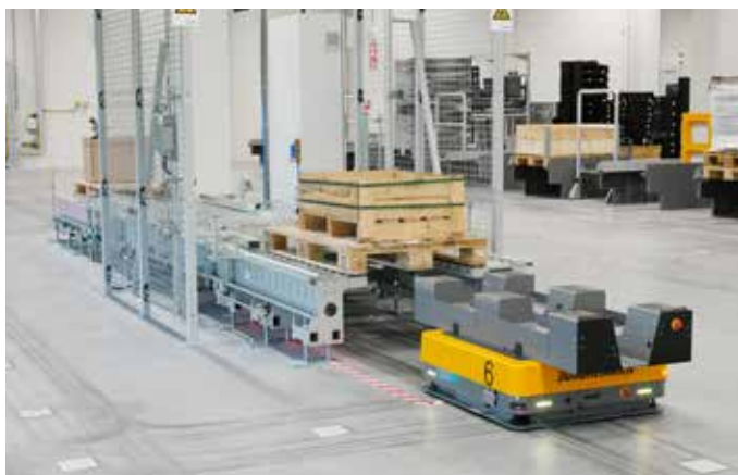
Na elke pickopdracht worden de contouren van de pallets gecontroleerd, voordat ze worden opgeslagen in het hoogbouwmagazijn.
