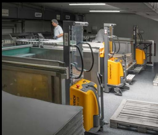
Stets auf optimaler Griffhöhe: Als Arbeitstisch mit Fördertechnik stellt der Elektro-Hochhubwagen HC 110 Leerdosen für die Produktion bereit.
