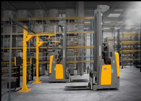
24/7-Verfügbarkeit garantiert: Zeiten ohne Fahraufträge nutzt das FTS, um seine Lithium-Ionen-Batterie an einer Automatik-Ladestation zwischenzuladen.
