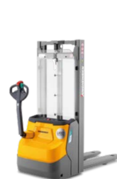
EJC 110i/112i** Podnośnikowy wózek widtowy Maks. wys. podn.: 4 700 mm Maks. udźwig: 1 200 kg Opcjonalnie z pojedynczym masztem
