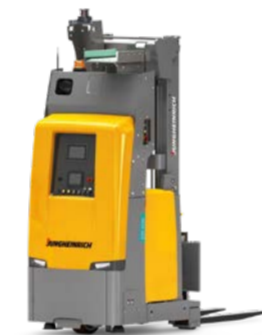
EKS 215a Robot mobilny Do transportu poziomego i pionowego Maks. wys. podn.: 6 000 mm Maks. udźwig: 1 500 kg
