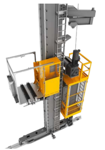
STP Układnica do palet Maks. wys. podn.: do 30 000 mm Maks. udźwig: 1 500 kg
