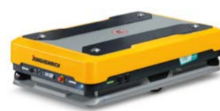
arculee M Robot mobilny Transport na platformach Maks. udźwig: 1 300 kg
