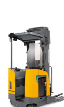
ETR 214-320/316d Pantograf Maks. wys. podn.: 11 354 mm Maks. udźwig: 2 000 kg
