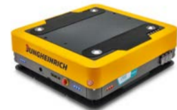
arculee S Robot mobilny Transport na platformach Maks. udźwig: 920 kg
