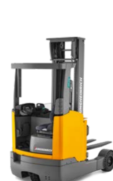
ETV C16/C20 Wózek widtowy wysokiego składowania Maks. wys. podn.: 7 400 mm Maks. udźwig: 2 000 kg
