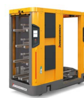
SOTO Robot mobilny Obsługa pojemników Maks. liczba pojemników: 24 Maks. masa pojemników: 20 kg
