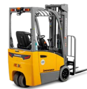
EFG BA 113/115 Czołowy trójkołowy wózek widłowy Maks. wys. podn.: 6 500 mm Maks. udźwig: 1 500 kg
