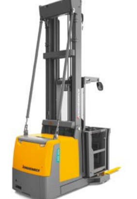
EKS 310s/412s*** Wózek widtowy do kompletacji pionowej Maks. wys. podn.: 14 345 mm Maks. udźwig: 1 200 kg
