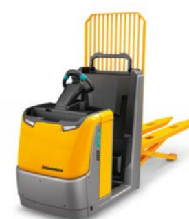
ECE 310/320 Wózek widtowy do kompletacji poziomej Maks. udźwig: 2 000 kg Opcja: easyPILOT
