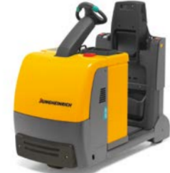
EZS C40 Ciągnik akumulatorowy obsługiwany w pozycji stojącej Maks. uciąż: 4 000 kg
