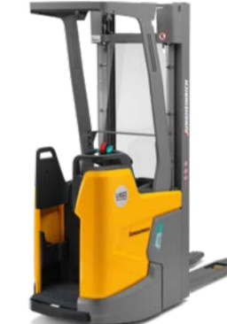
ERC 214i/216i** Podnośnikowy wózek widtowy z li-ion Maks. wys. podn.: 6 000 mm Maks. udźwig: 1 600 kg
