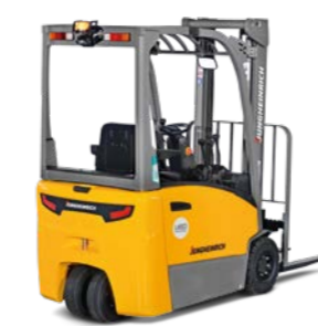
EFG BB 216k Czołowy trójkołowy wózek widłowy Maks. wys. podn.: 6 500 mm Maks. udźwig: 1 600 kg
