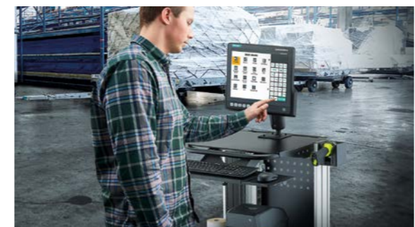
TERMINALE, SKANERY I WYPOSAŻENIE Terminale w wózkach oraz ręczne terminale do cyfrowego przetwarzania zleceń. Bezbłędne oznaczanie i rejestracja za pomocą przemysłowych drukarek etykiet oraz skanerów kodów kreskowych. Dostosowana do klienta analiza infrastruktury WLAN w celu optymalizacji mobilnej rejestracji danych. Mobilne stanowiska pracy do elastycznego rozmieszczenia skanerów, drukarek i terminali.
