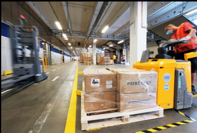
Das Fahrerlose Transportsystem ERC 215a arbeitet bei FOXCONN im Mischbetrieb zwischen weiterer Fördertechnik und Lagermitarbeitern.
