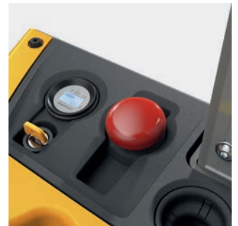
Der EJC M: Alle wichtigen Kontrollinstrumente sind zentral angeordnet: Batterieladeanzeige, Betriebsstundenzähler, Notauschalter und Schlüssel.
