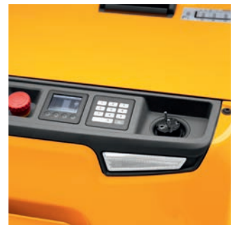
Mit eingebautem Ladegerät für schnelles, einfaches Zwischenladen an jeder 230-V-Steckdose.
