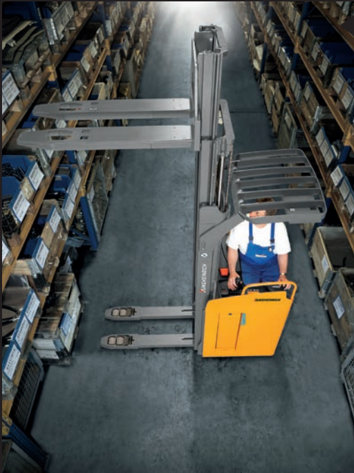
ESC 216z: Die Radarme können unabhängig von den Gabeln angehoben werden (Radarmhub). Ideal für den Transport auf unebenem Boden.
