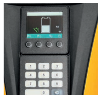
EMC 110: 2-Zoll-Fahrzeugdisplay inklusive Entladeanzeige und Betriebsstundenzähler (optional).
