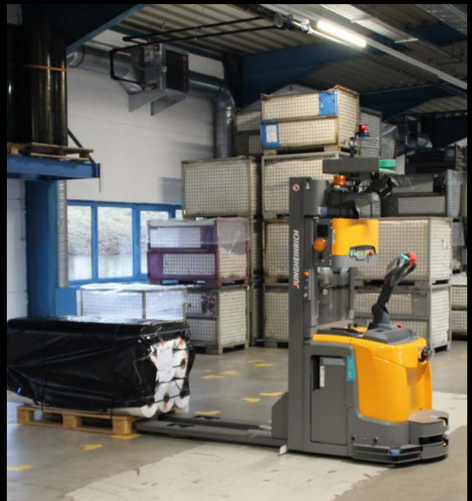
Wiederkehrende Tätigkeiten in den Lagerabläufen werden vollautomatisch durch das FTS übernommen.
