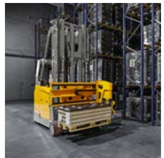
Der ETX 515a ist für den manuellen, den Semiautomatik- oder den Automatik-Einsatz gerüstet. Eine stufenweise Automatisierung ist möglich.
