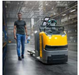
Das mobile Bediensystem easyPILOT steuert intuitiv und sicher den nächsten Kommissionierplatz an und entlastet so den Mitarbeiter.
