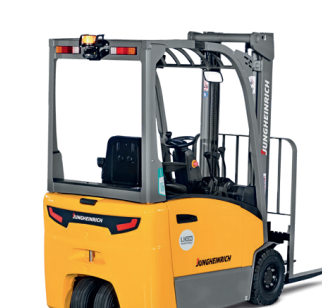
EFG BB 216k Elektrisk trehjuls motvektstruck Maks. løftehøyde: 6500 mm Maks. løftekapasitet: 1600 kg
