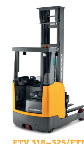
ETV 318-325/ETM 325 Skyvemastruck Maks. løftehøyde: 14 000 mm Maks. løftekapasitet: 2500 kg
