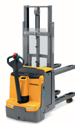
EJD 118i/120/222 Elektrisk topalls støttebenstruck Maks. løftehøyde: 2905 mm Maks. løftekapasitet: 2200 kg
