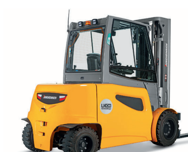
EFG 535k-550 Elektrisk firehjuls motvektstruck Maks. løftehøyde: 7500 mm Maks. løftekapasitet: 5000 kg
