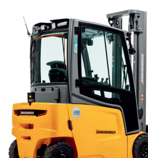
EFG 316-320 Elektrisk firehjuls motvektstruck Maks. løftehøyde: 7000 mm Maks. løftekapasitet: 2000 kg
