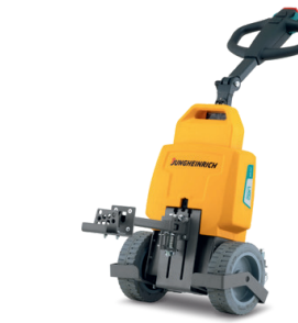
EZO 010 Elektrisk trekktruck Maks. trekkraft: 1000 kg
