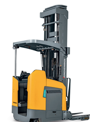
ETR 420/416d Skyvemastruck Maks. løftehøyde: 11 354 mm Maks. løftekapasitet: 2000 kg
