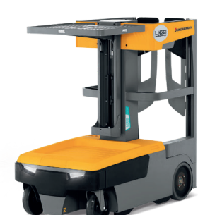
EKM 202 Personløfter for plukking Maks. plukkhøyde: 5324 mm Maks. løftekapasitet: 215 kg
