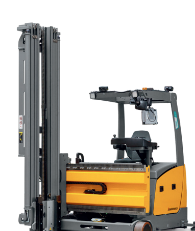
EFX 411/414 Smalgangstruck Maks. løftehøyde: 9000 mm Maks. løftekapasitet: 1360 kg
