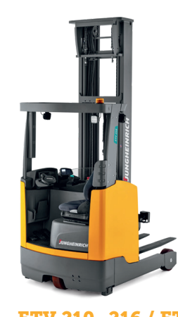
ETV 210-216 / ETM 214/216 Skyvemastruck Maks. løftehøyde: 10 700 mm Maks. løftekapasitet: 1600 kg
