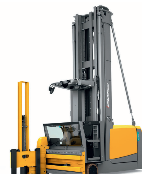
EKX 410-516k Smalgangs-/kombitruck Maks. løftehøyde: 18 000 mm Maks. løftekapasitet: 1600 kg
