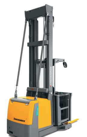
EKS 210-412 Plukktruck Maks. plukkhøyde: 10 845 mm Maks. løftekapasitet: 1200 kg
