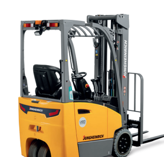
EFG BA 113/115 Elektrisk trehjuls motvektstruck Maks. løftehøyde: 6500 mm Maks. løftekapasitet: 1500 kg
