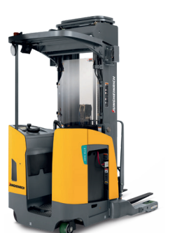
ETR 214-320/316d Skyvemastruck Maks. løftehøyde: 11 354 mm Maks. løftekapasitet: 2000 kg
