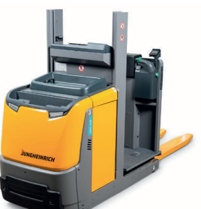
EKS 110 Plukktruck Maks. plukkhøyde: 4600 mm Maks. løftekapasitet: 1000 kg
