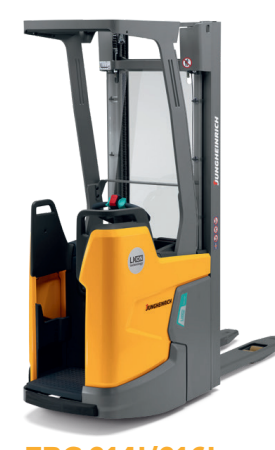
ERC 214i/216i Elektrisk støttebenstruck med fast førerplattform Maks. løftehøyde: 6000 mm Maks. løftekapasitet: 1600 kg
