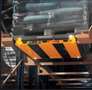
Nel magazzino compatto sono i maneggevoli shuttle ad eseguire il trasporto.
