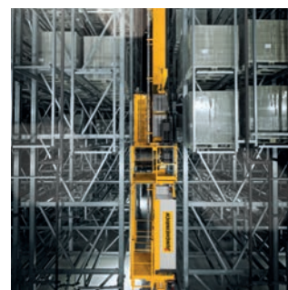
Trasloelevatore per pallet: velocità e precisione durante il processo di deposito e prelievo.
