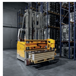
L' ETX 515a è equipaggiato per l'uso manuale, semi-automatico o automatico. È possibile l'automatizzazione graduale.
