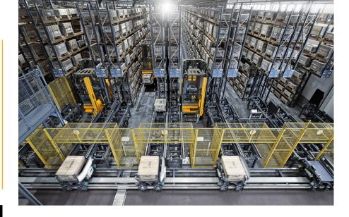
SKF setzt beim Umbau des Logistikzentrums auf eine Automatiklösung von Jungheinrich: 16 fahrerlose Elektro-Kommissionierer vom Typ EKX 516a sorgen im 18-gassigen Hochregallager für maximale Produktivität.
