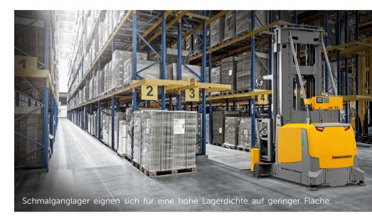
Routen des EKXa effizient. Paletten- und Freiraumerkennung mittels Kamera und Sensorik ermöglichen die Automatisierung von manuellen Bestandsregalen.
