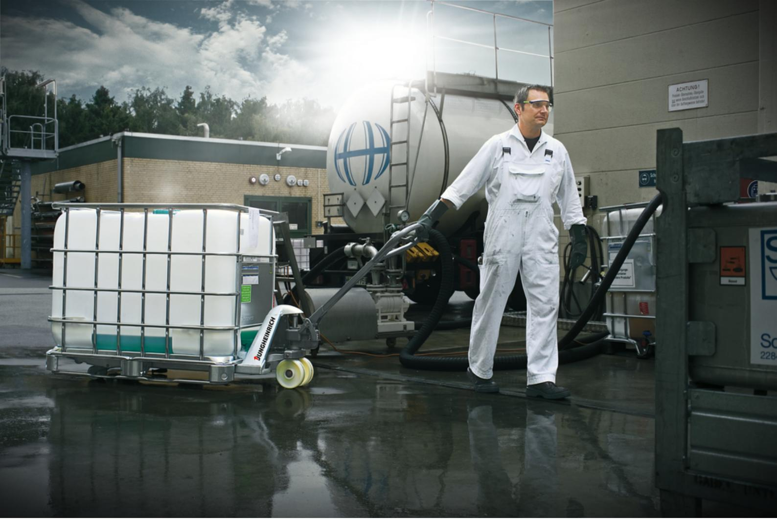
Ручний гідравлічний візок з гальванічним покриттям
