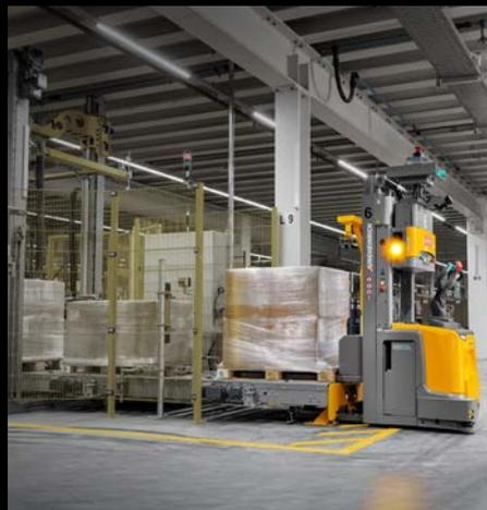
Für den sicheren Transport der Waren werden Paletten mit Stretchfolien eingewickelt. Die eigens entwickelte Schnittstellenlösung AGV/AMR Connector des Jungheinrich Logistics Interface ermöglicht einen durchgängigen, automatisierten Materialfluss zwischen den Palettenstretchern und den Mobile Robots.
