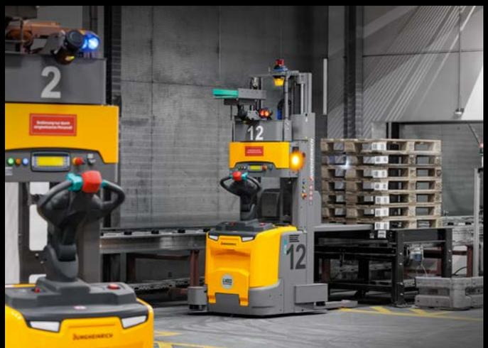
Die Mobile Robots steuern Auf- und Abnahmepunkte an. Neben passenden Schnittstellen waren enge Fahrwege aufgrund der gewachsenen Strukturen eine Herausforderung bei der Automatisierung.
