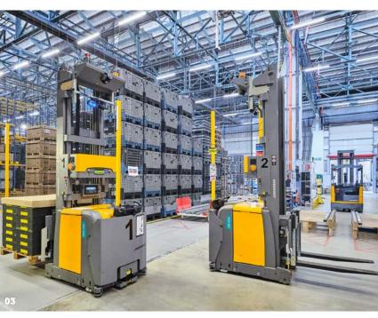
Tragfähigkeit: 1,5 t. Hubhöhe: 5 m. Fahrgeschwindigkeit: bis zu 9 km/h.
