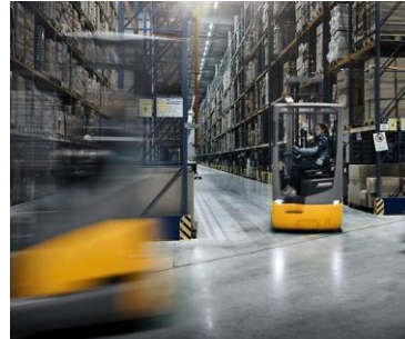
Assistenzsysteme regulieren Fahr- und Hubgeschwindigkeit, erhöhen die Stabilität in Kurven und verhindern Kollisionen.
