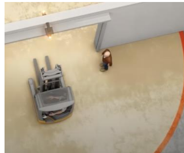
Intelligentes Gefahrenzonenmanagement durch das funkbasierte Assistenzsystem zoneCONTROL.
