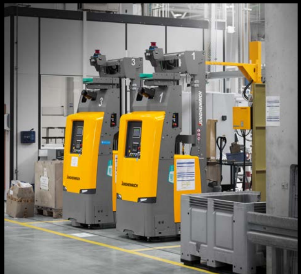
Allzeit bereit: Via Jungheinrich Logistics Interface empfängt der EKS 215a Transportaufträge in priorisierter Reihenfolge und arbeitet diese zuverlässig ab.
