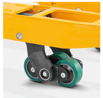
silentDRIVE (optional) sorgt für geringe Fahr- und Hubgeräusche. Perfekt für entspanntes Arbeiten in der Filiale und geräuschten Umgebungen.
