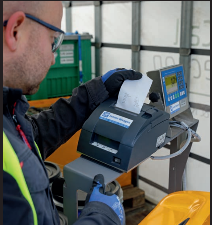
Ein Kundenbeleg über das Gewicht der abgeholt Altbatterien kann direkt an der eingebauten Wiegeeinheit ausgedruckt werden.
