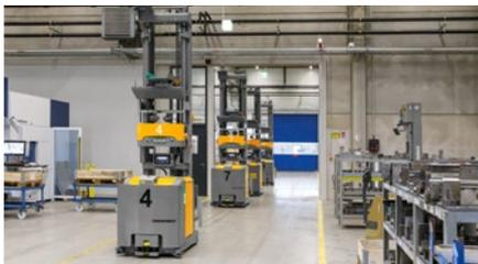
Verteilt über die gesamte Produktionsstätte verrichten Mobile Robots bei **RIKA** bis zu 1.000 Transporte am Tag.
