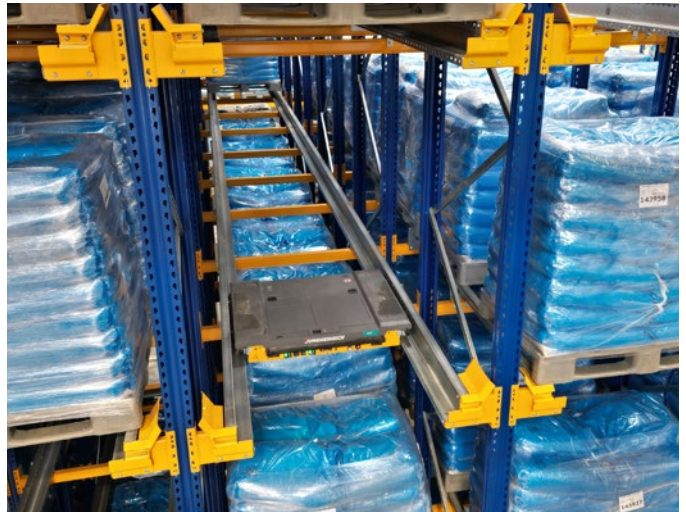
De UPC shuttle van Jungheinrich combineert compacte opslag met hoge omloopsnelheden.
