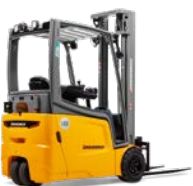
EFG 213-220 Elektrische driewielvorkheftruck Max. hefhoogte: 7.000 mm Max. draagvermogen: 2.000 kg
