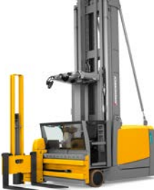
EKX 410-516k*** Smallegangentruck man-up Max. hefhoogte: 18.000 mm Max. draagvermogen: 1.600 kg
