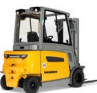
EFG 425-435 Elektrische vierwielvorkheftruck Max. hefhoogte: 7.500 mm Max. draagvermogen: 3.500 kg
