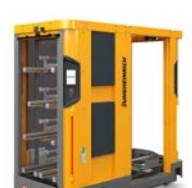
SOTO AMR Handling van containers Max. aantal containers: 24 Max. gewicht container: 20 kg
