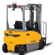
EFG BC 316-330 Elektrische vierwielvorkheftruck Max. hefhoogte: 6.500 mm Max. draagvermogen: 3.000 kg
