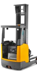
ETV 318-325 / ETM 325 Reachtruck Max. hefhoogte: 14.000 mm Max. draagvermogen: 2.500 kg
