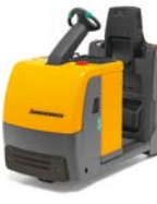
EZX C40 Elektrische trekker Max. trekkracht: 4.000 kg
