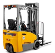
EFG BA 113 / 115 Elektrische driewielvorkheftruck Max. hefhoogte: 6.500 mm Max. draagvermogen: 1.500 kg
