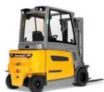
EFG 425-435 Chariot élévateur à fourche électrique à quatre roues Hauteur de levée max. : 7 500 mm Capacité de charge max. : 3 500 kg
