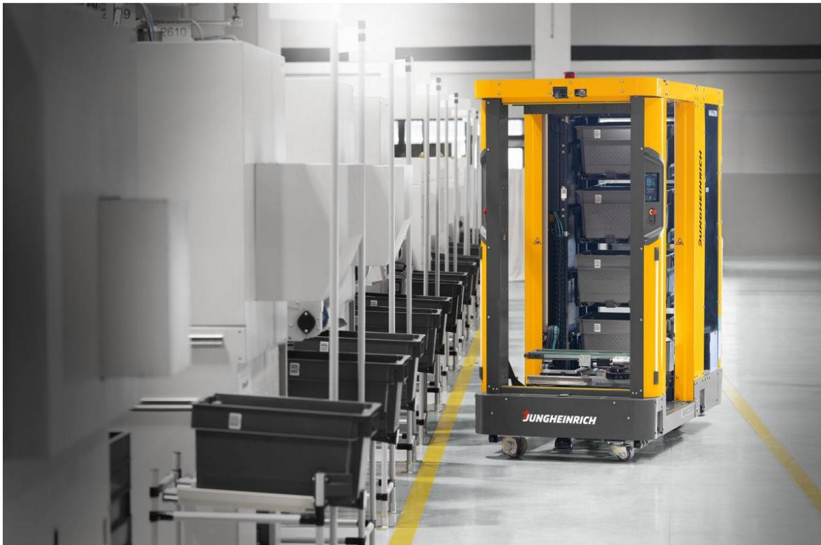
BU: Nach den gesammelten Erfahrungen aus einem Pilotprojekt erweitert WAGO seine AMR-Flotte auf insgesamt vier SOTO-Roboter. Sie übernehmen den automatisierten Transport von Kleinladungsträgern zwischen Logistikbereich und Produktion.
