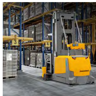
Pri neprekinjenem upravljanju EKXa črpa energijo neposredno iz vodil na regalu.
