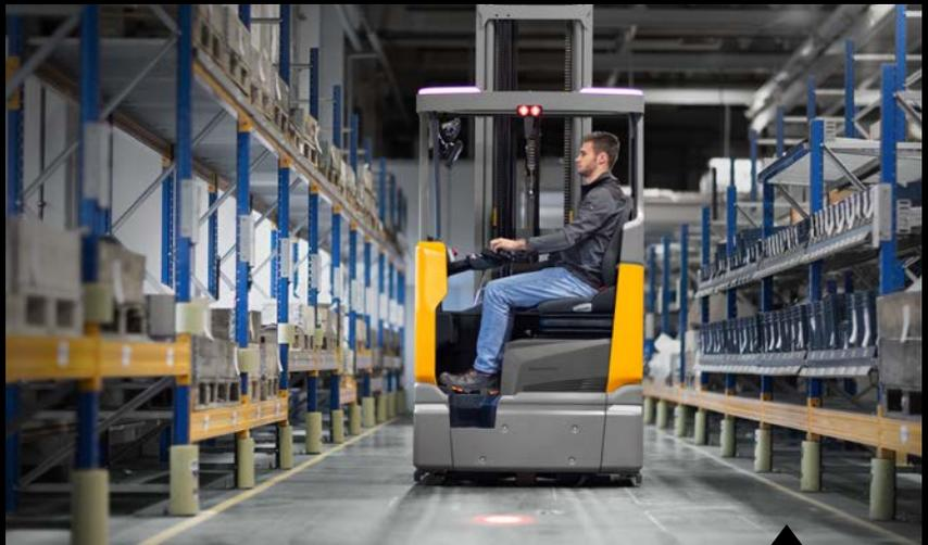
Un Floor-Spot integrado proporciona una advertencia visual en el sentido de marcha, complementado por sistemas de asistencia probados de Jungheinrich como curveCONTROL y driveCONTROL.
