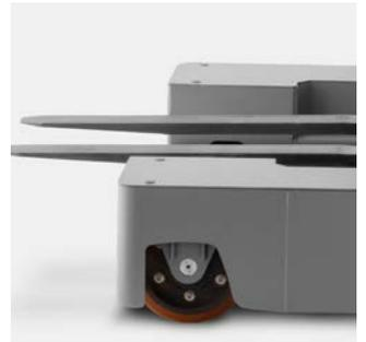
El ETV Q tiene ruedas de carga orientables y frenables para maniobrar con mayor seguridad en desplazamientos transversales.
