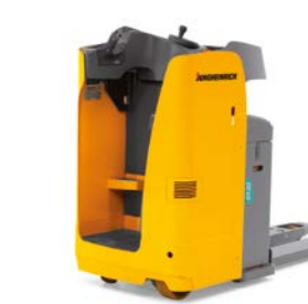
ESE 120 Elektrický nízkozdvížný vozík s plošinou na státie Max. nosnosť: 2 000 kg
