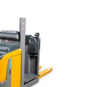
EKS 110 Vertikálny vychystávací vozík Max. výška vychystávania: 4 600 mm Max. nosnosť: 1 000 kg
