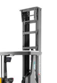
ETV 214i/216i Vysokozdvížný vozík s výsuvným zdvíhacím zariadením Max. výška zdvihu: 10 700 mm Max. nosnosť: 1 600 kg
