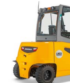
EFG 535k-550 Elektrický 4-koľosový vysokozdvížný vozík Max. výška zdvihu: 7 500 mm Max. nosnosť: 5 000 kg
