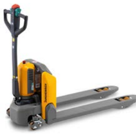
AME 13/15/16 Elektrický ručne vedený nízkozdvížný vozík Max. nosnosť: 1 600 kg
