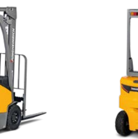
EFG BB 216k Elektrický 3-koľosový vysokozdvížný vozík Max. výška zdvihu: 6 500 mm Max. nosnosť: 1 600 kg
