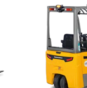
EFG BB 216k Elektrický 3-koľosový vysokozdvížný vozík Max. výška zdvihu: 6 500 mm Max. nosnosť: 1 600 kg
