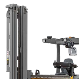
EFX 411/414*** Trojstranný zakladací vysokozdvížný vozík Max. výška zdvihu: 9 000 mm Max. nosnosť: 1 360 kg
