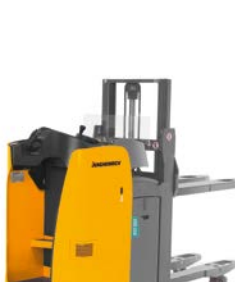
ESD 120 Elektrický vysokozdvížný vozík pre dvojúrovňové nakladanie s plošinou na státie Max. výška zdvihu: 1 960 mm Max. nosnosť: 2 000 kg
