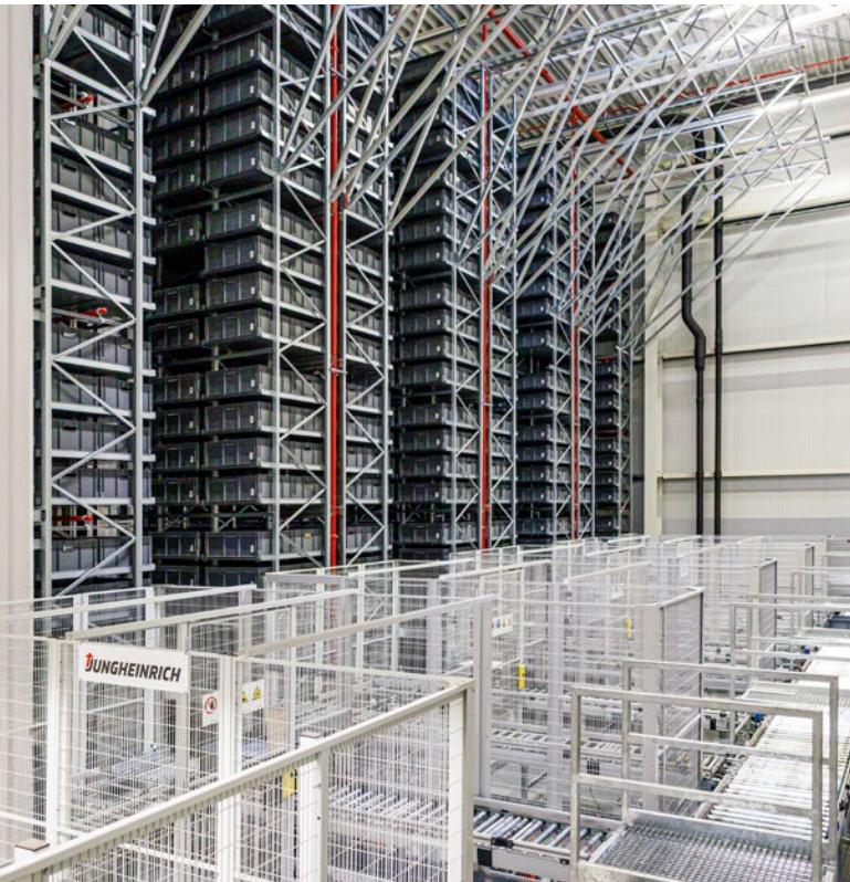
Aus dem Zentrlallager werden täglich tausende Sportartikel in die ganze Welt versendet. Den Hauptteil bildet das automatisierte Behälter-Kleinteilelager mit 36.000 Stellplätzen. Das Zusammenspiel zwischen Mensch und Maschine funktioniert hier perfekt.
