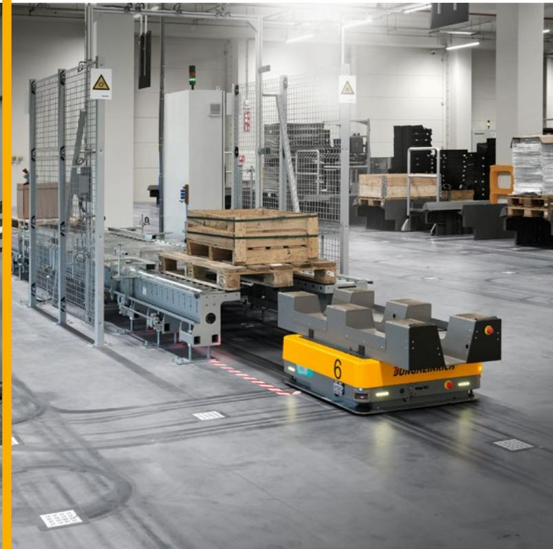
Jungheinrich lieferte ein System aus Mobile Robots, Staplern, Regalen, Software und die Anbindung an das ERP-System. 15 arculee transportieren die Ware zum Hochregallager, wo diese dann von acht automatisierten Schmalgangstaplern eingelagert werden.
