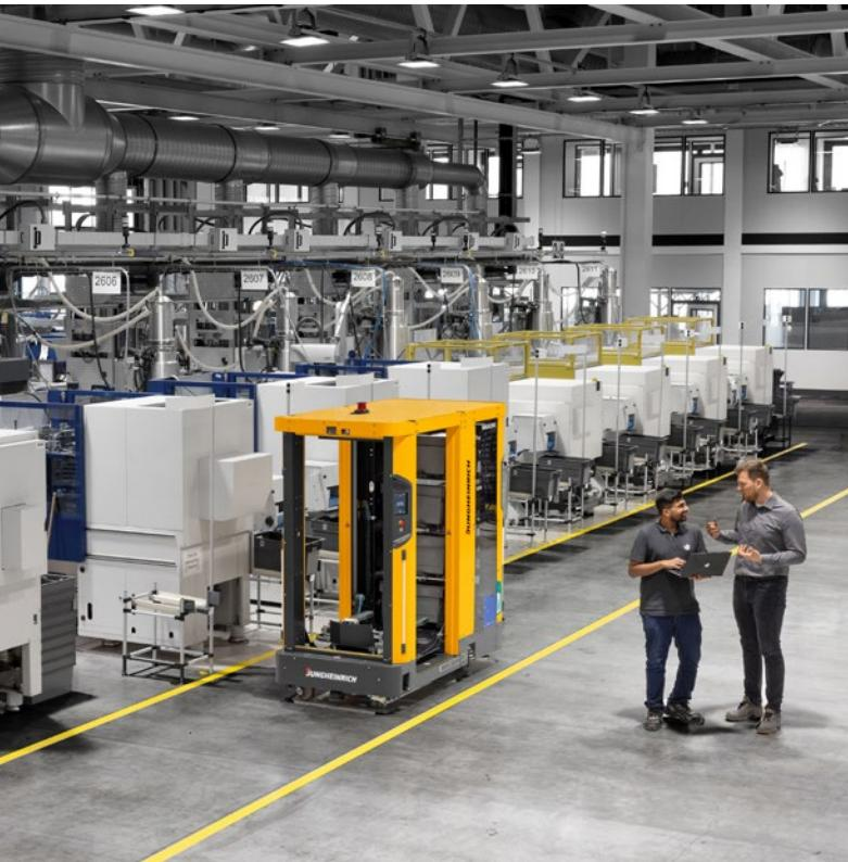
Bei WAGO übernimmt der SOTO die autonome Versorgung der Spritzgussmaschinen mit Kleinladungsträgern. Dank standardisierter VDA-5050-Schnittstelle können in Zukunft weitere automatisierte Fahrzeuge einfach integriert werden.
