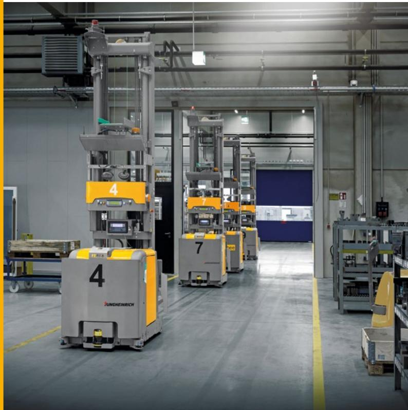
RIKA setzt für die Puffer-Lagerung der Zwischen- und Endprodukte auf eine Kombination aus neun Fahrerlosen Transportfahrzeugen, Lithium-Ionen-Technologie mit automatischen Ladestationen und das Jungheinrich Logistik-Interface.
