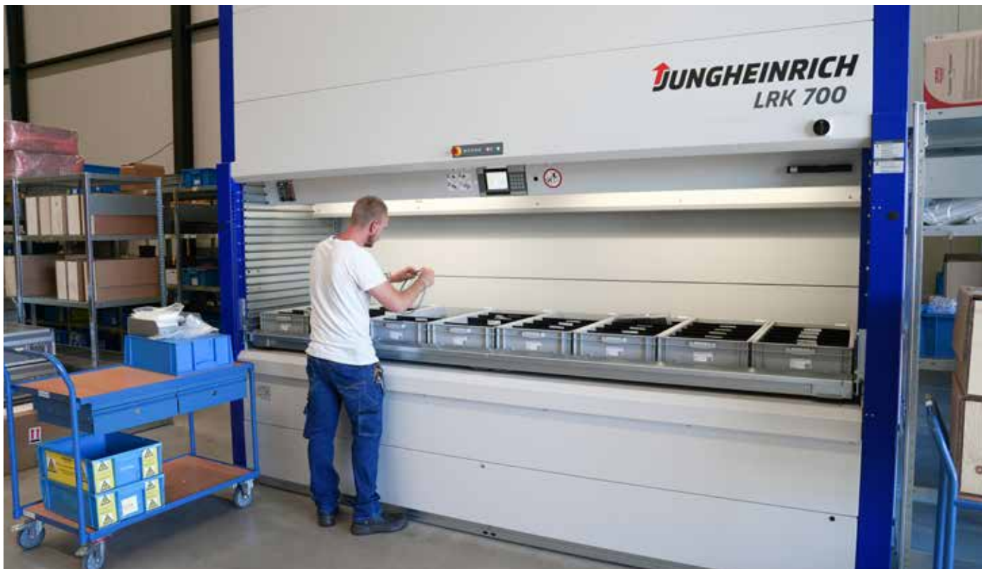
De plateaulift maakt een compacte en stofvrije opslag mogelijk van kostbare goederen.
