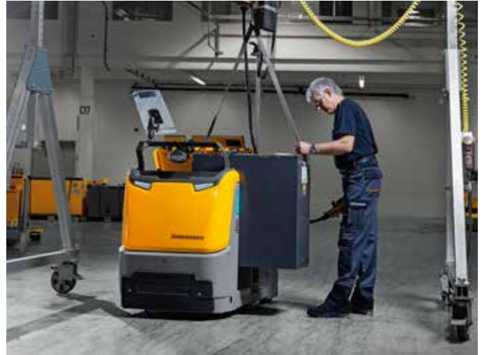
Hier zijn de professionals aan zet: voorzichtige demontage van de lithium-ion accu uit een gebruikte truck.
