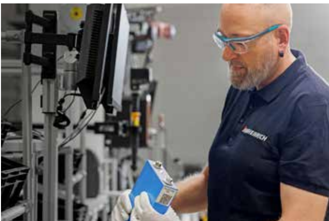
Een gebruikte accustack van dichtbij bekeken: alleen cellen die alle tests doorstaan kunnen worden hergebruikt.
