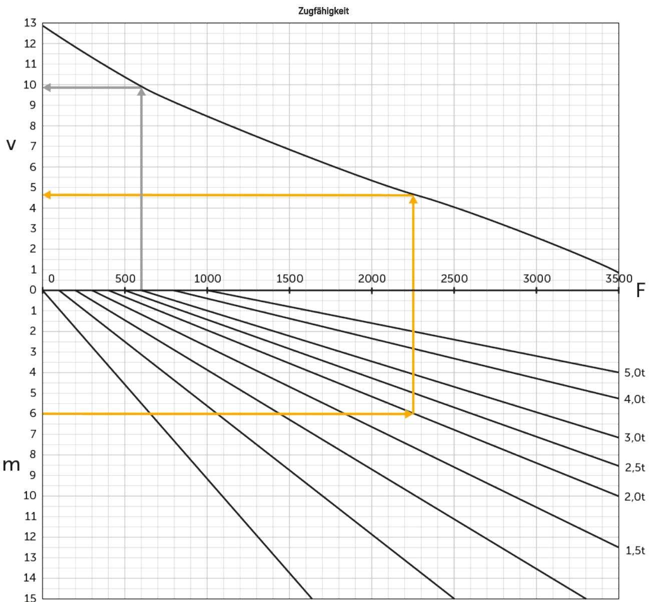
**v**=Geschwindigkeit [km/h], **m**=Steigung [%], **F**=Zugkraft [N]
