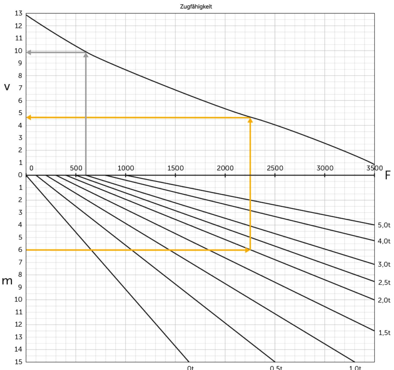
$v$ =Geschwindigkeit [km/h],  $m$ =Steigung [%],  $F$ =Zugkraft [N]
