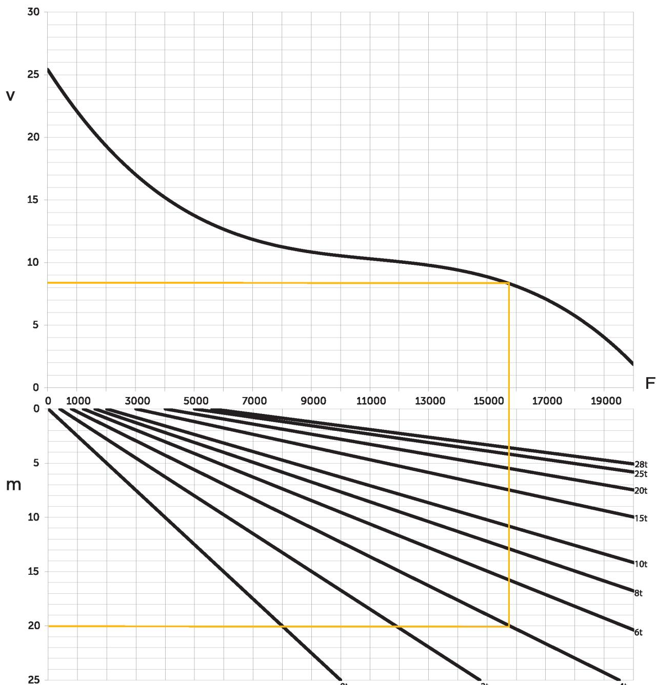
v=velocidade [km/h], m=subida [%], F=força de tração [N]
